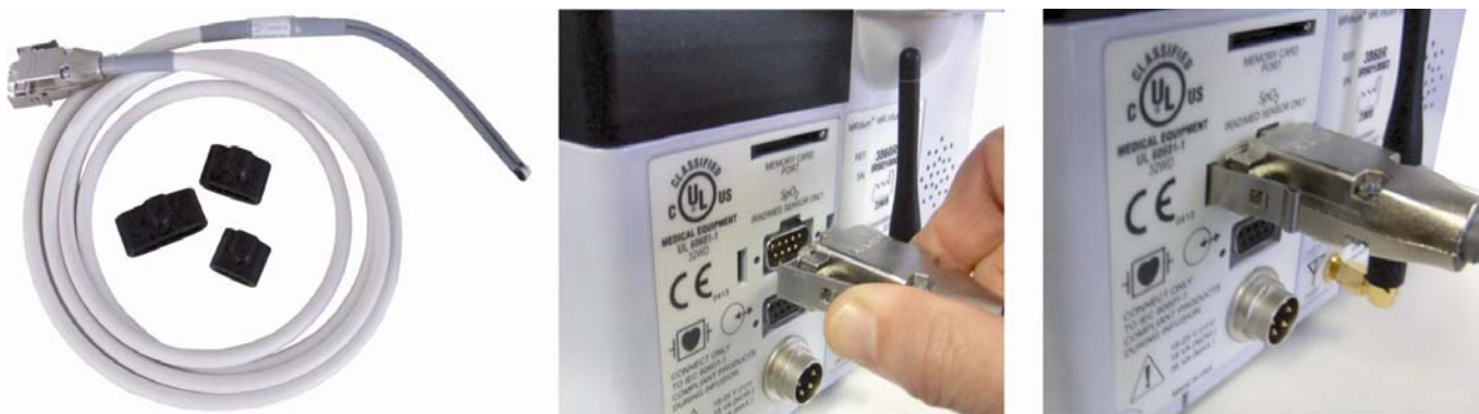
Figura 7-2. Collegamento della sonda in fibra ottica 1170
