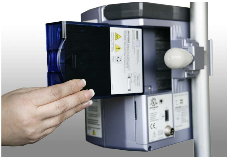
Figura 6-1. Installazione della batteria
