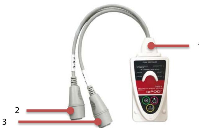
1. Accertarsi che il connettore a doppi canale (1) della serie 1860 sia fissato meccanicamente e saldamente collegato all'ipPOD IBP.
