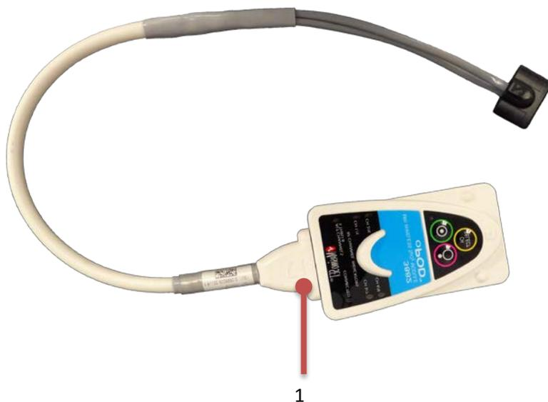
Il cavo del sensore SpO<sub>2</sub>, P/N 1821 è realizzato in fibra ottica (vetro) e abbinato all'oPOD SpO<sub>2</sub>.
